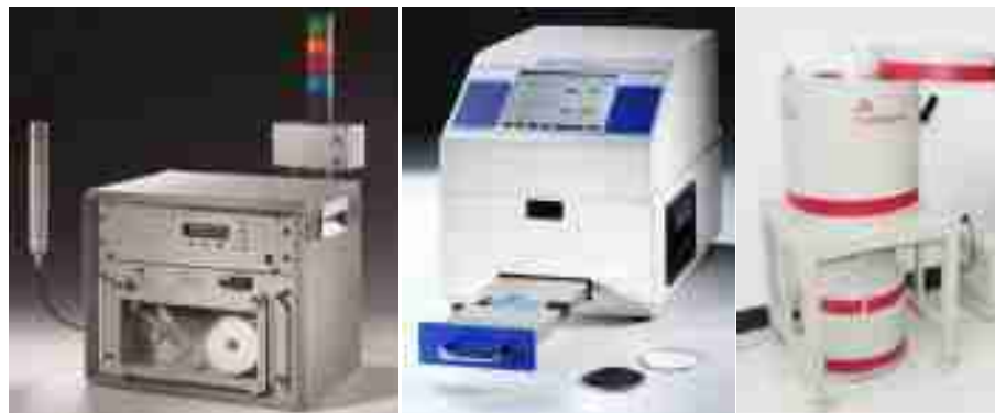
图 4-37 空气气溶胶（微粒）自动采样仪（左）样品 \alpha/\beta 辐射监测仪（中）高纯锗 \gamma 射线谱仪（右）
