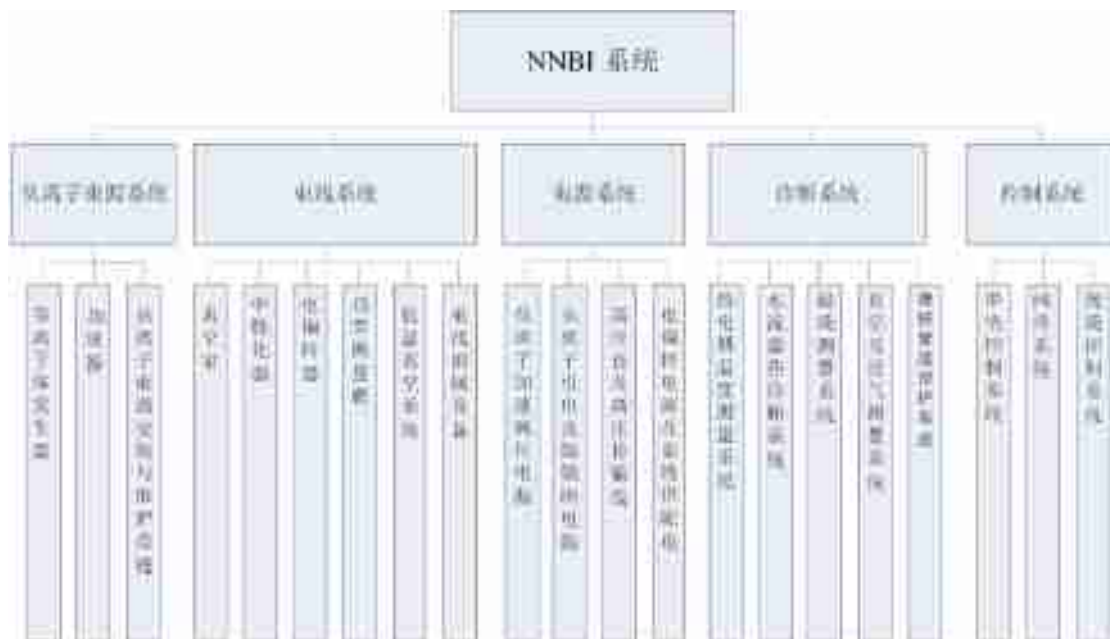
图 3-37 中性束注入加热 NNBI 系统构成方框图
