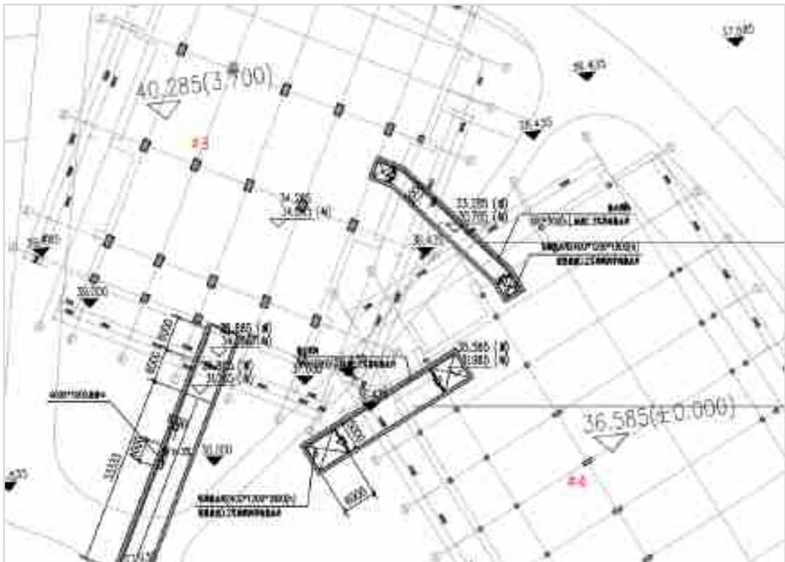
图 3-8 3#楼与 4#楼之间管廊连接示意图
