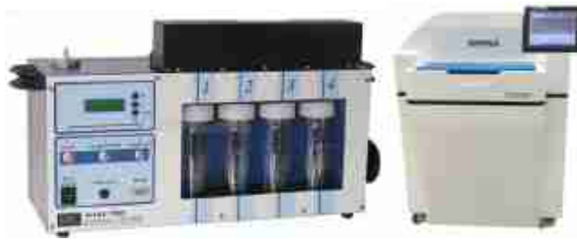
图 4-36 气氚、水氚综合采样器（左）低本底液闪 \beta/\gamma 射线谱仪（右）
