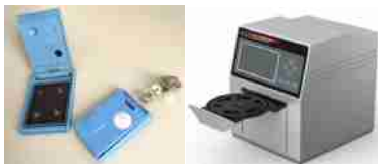
图 4-34 光释光/固体核径迹片（热释光）个人剂量计（左）累积剂量读出器（右）
