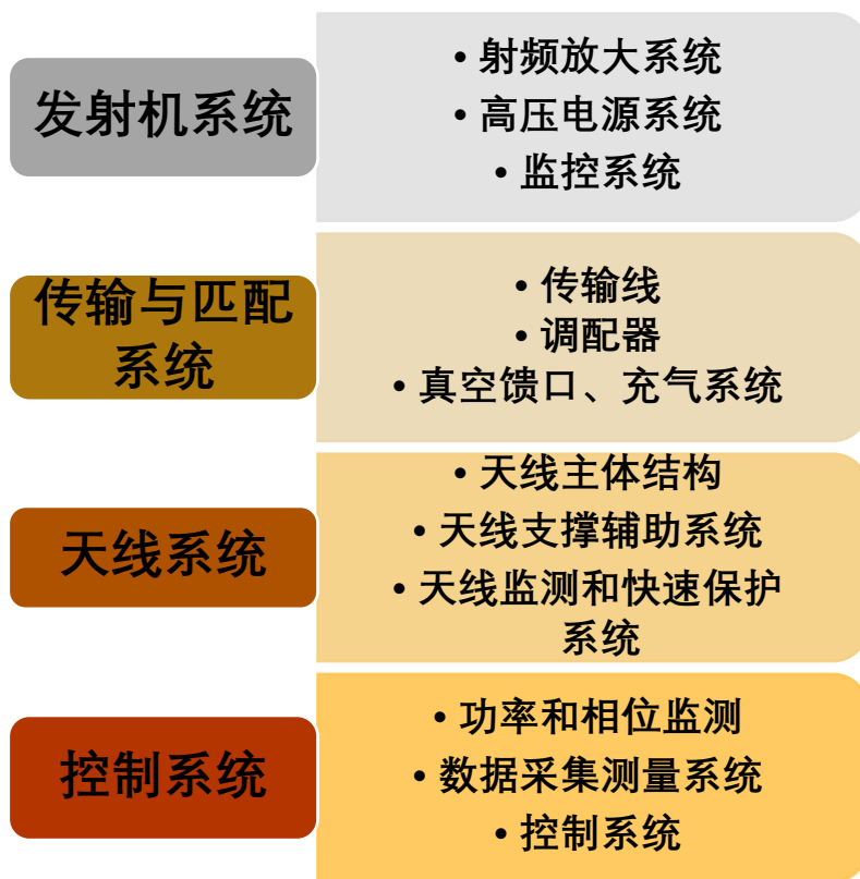
图 3-35 BEST 离子回旋子系统主要架构
