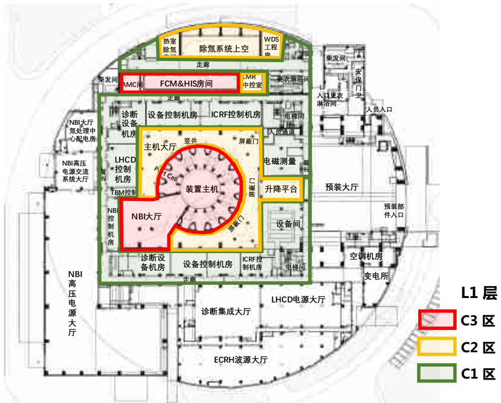
图 4-6 BEST 装置大楼 L1 层氚包容分区
