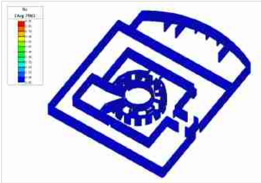
图 5-30 4~5 层剪力墙及连梁损伤
